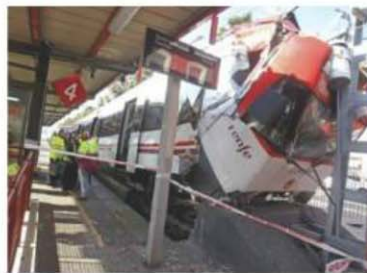
Impacto de tren de cercanías contra las toperas de la estación Mataró.
